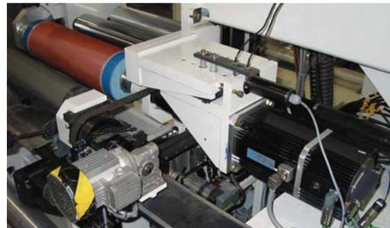
Bild 2: Druckwerk der Versuchsmaschine mit Direktantrieb
