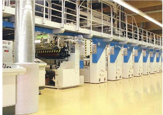
Bild 1: Flexodruckmaschine mit vergleichbarer Bauart wie die Versuchsmaschine (BHS Druck- und Veredelungstechnik)
