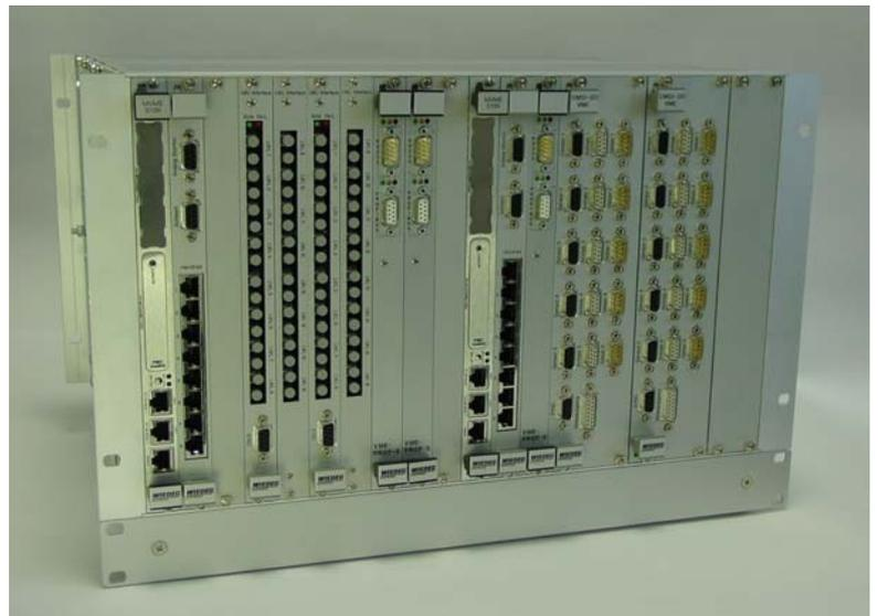
IASP-Antriebs-Steuerung für eine Druckmaschine
